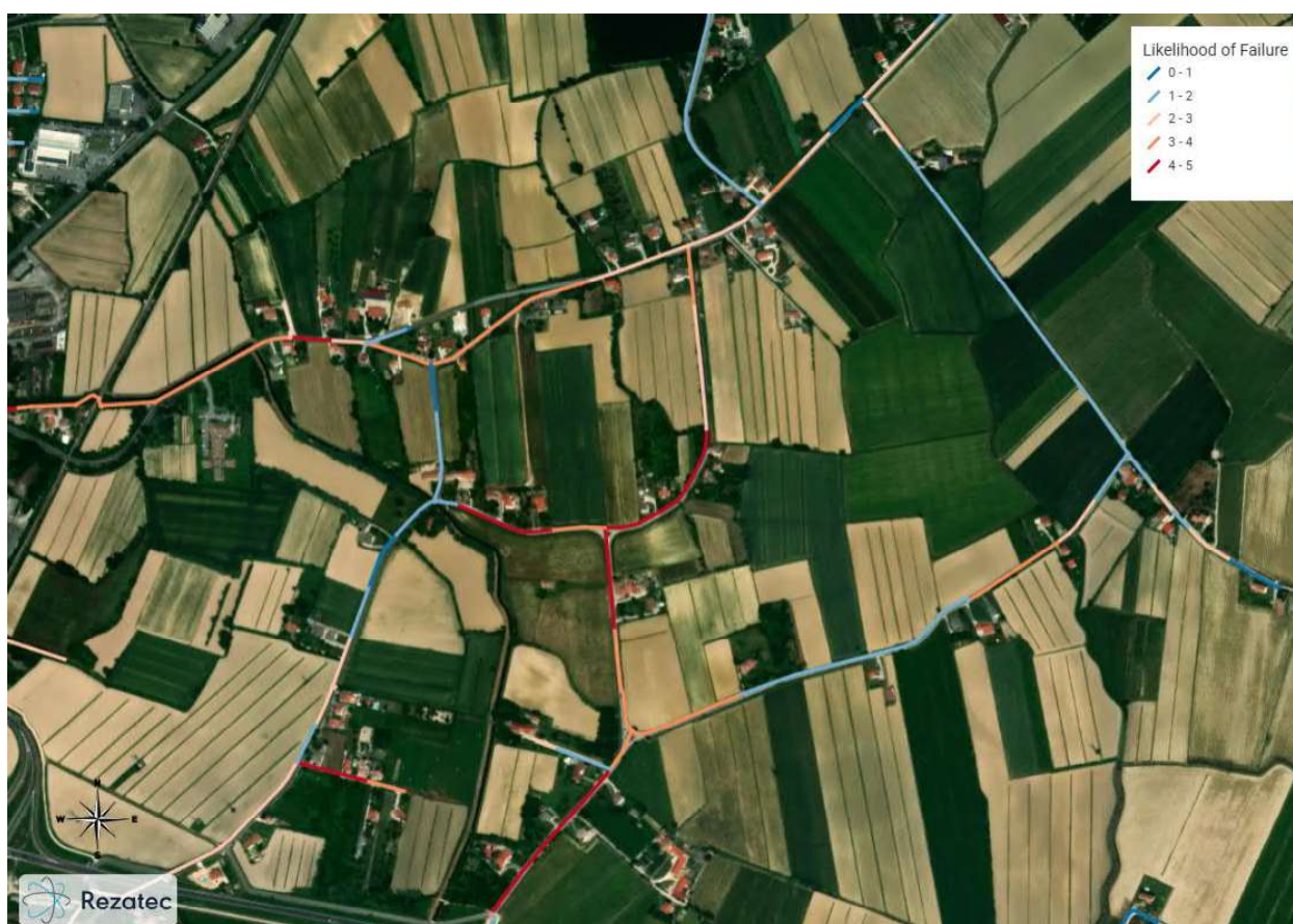
Figura 1: LoF (Likelihood of Failure) in Via Nosedo e Fossalato.
