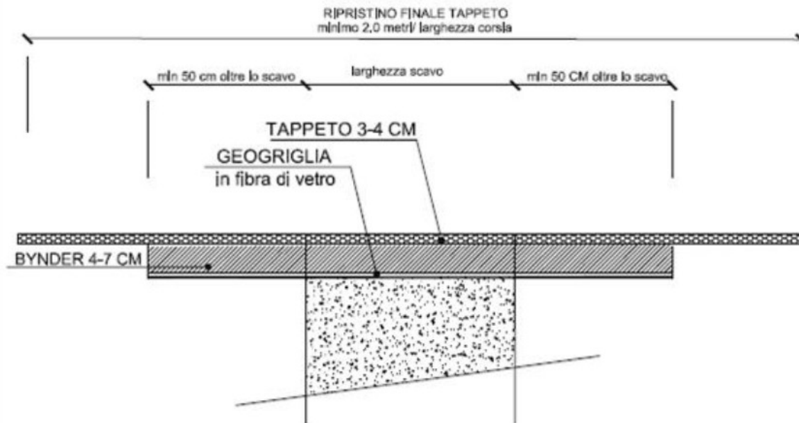
SEZIONE TIPOLOGICA Ripristino dello stato finale
