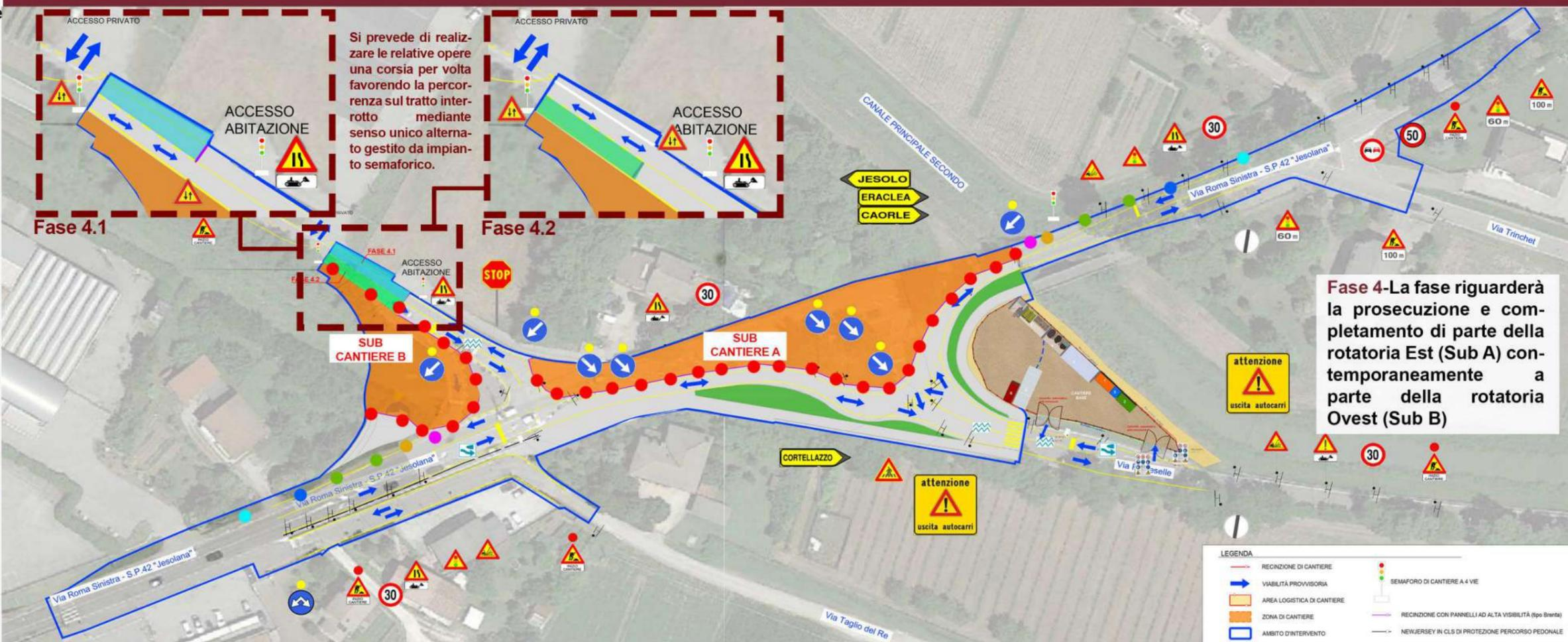
**Fase 4-La fase riguarderà la prosecuzione e completamento di parte della rotatoria Est (Sub A) contemporaneamente a parte della rotatoria Ovest (Sub B)**
