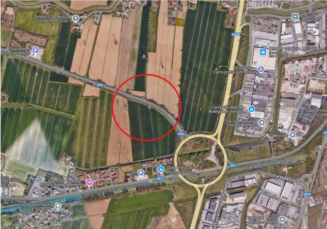
Il nuovo tracciato stradale si sviluppa interamente in campagna salvo i raccordi alla viabilità esistente, per una lunghezza complessiva di 230 metri con una sezione di categoria C – Extraurbane Secondarie tipo C1 secondo quanto previsto dal D.M. 05/11/2001 “Norme funzionali e geometriche per la costruzione delle strade”.
