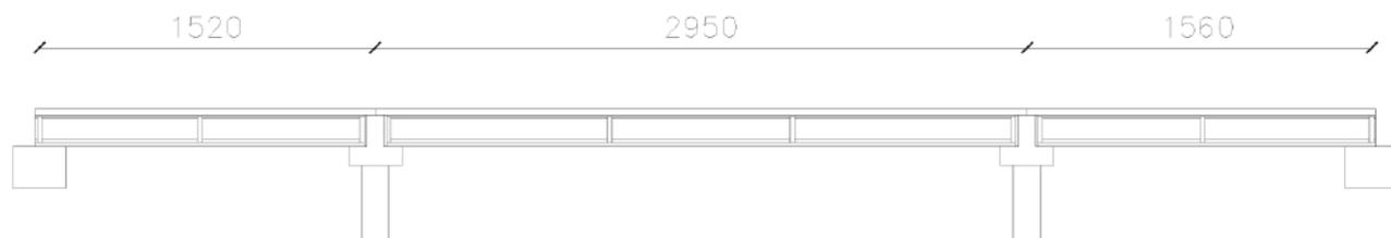
FIGURA 3-8: SEZIONE LONGITUDINALE DELL'IMPALCATO
