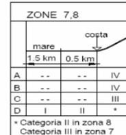
Quindi si procede a calcolare il coefficienti di esposizione valutandolo per ogni altezza delle pile dell'opera.
