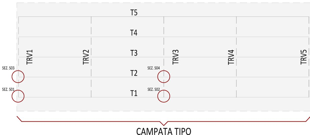
Figura 12-1 - Sezioni di verifica delle travi
