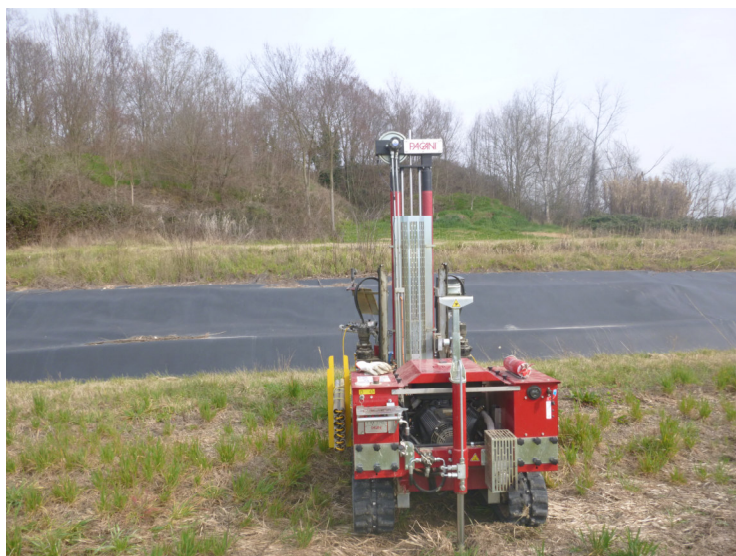
Esecuzione della prova CPTU2
