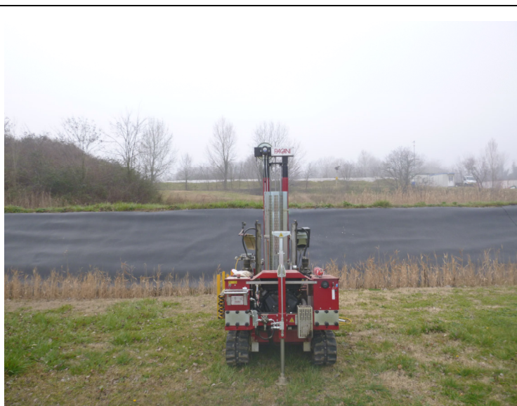
Esecuzione della prova CPTU3
