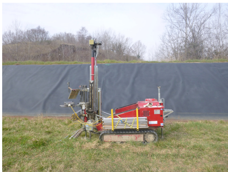
Esecuzione della prova CPTU5
