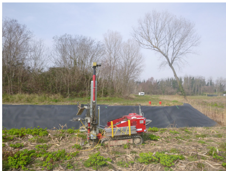
Esecuzione della prova CPTU4
