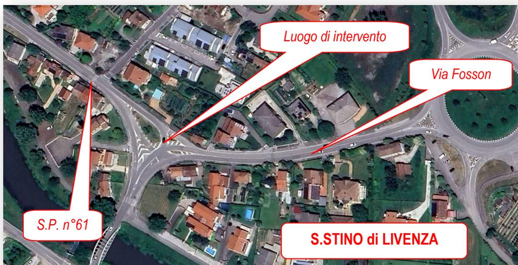
L'incrocio esistente si configura come un incrocio a raso a tre rami con presenza di aiuole spartitraffico sulle diverse canalizzazioni di svincolo. La S.P. n°61 nel tratto si configura come strada a unica carreggiata a una corsia per senso di marcia avente larghezza di circa 3.20 m. con banchine laterali di circa 0.40 m. , con in accostamento marciapiedi aventi larghezza media di ml. 1.75/2.15 elevati mediamente di cm. 12/15 dal piano viabile.
