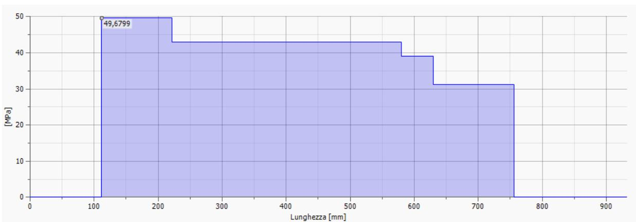
Figura 13: grafico dello sforzo di torsione sulla lunghezza dell'albero
