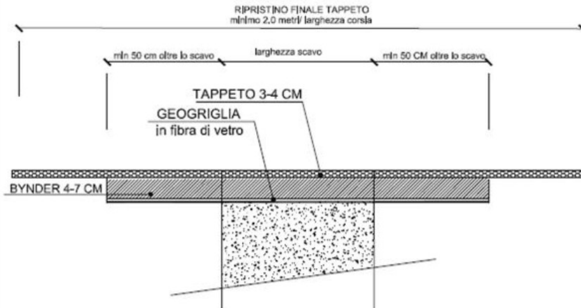
SEZIONE TIPOLOGICA Ripristino dello stato finale
